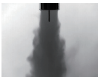
CO2を含むシールドガスの可視化
