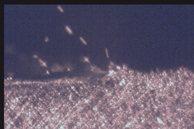
金属3Dプリンタ用粉末のレーザー照射による熔融凝固現象の可視化
