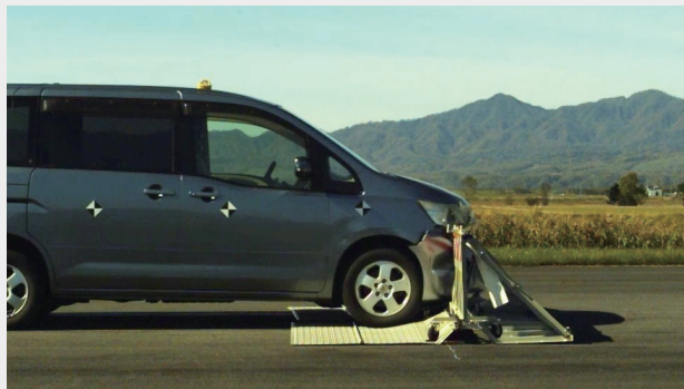
車両突入阻止バリアードの開発における実車衝突試験
