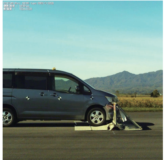
車両突入阻止バリケードの開発における実車衝突試験
