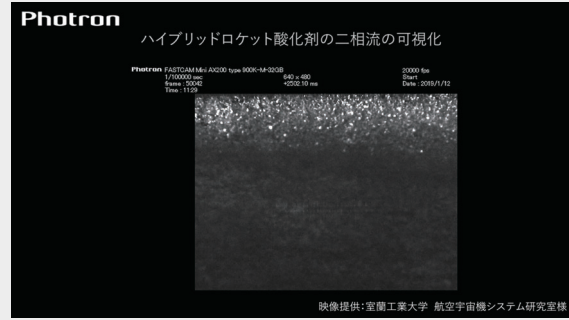
ハイブリッドロケット酸化剤の二相流の可視化
